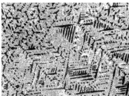
Рис. 3. Микроструктура сплава ПСр 45, непрерывное литье (Ø 29мм), (начало слитка)
