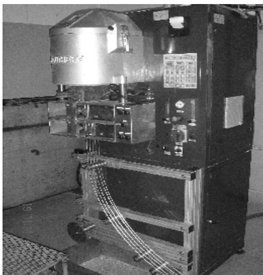
Рис. 1. Установка вертикального непрерывного литья СС 3000, режим литья пять ручьев Ø 5мм (Ag 99,99).
