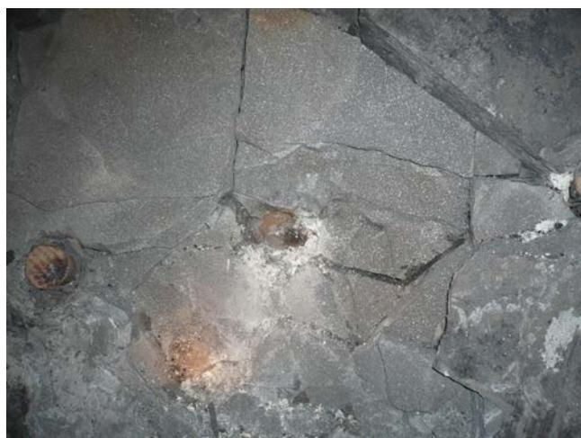
Рис. 4. Общий вид разрушенной породы в забое подрывки при разделке габаритов рельсового пути
