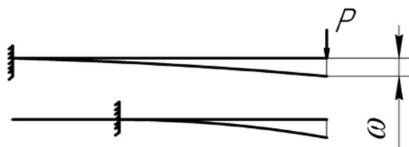
Рис. 4. Расчётная схема для оценки максимальной осевой силы возникающая в ШВП из-за погрешности замыкающего звена
