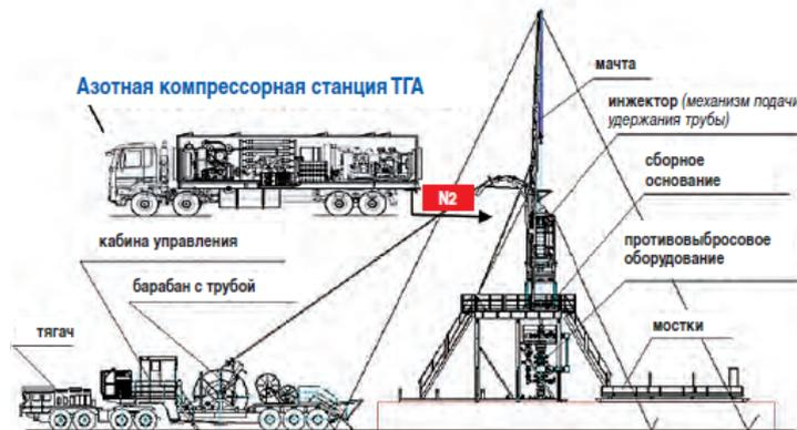
Рис.1. Применение азотной станции в технологической операции с использованием колтюбинга
