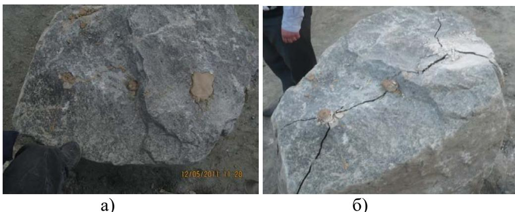
Рис. 1. Общий вид гранитного блока с расстоянием между шпурами 0,3м до разрушения (а) и после разрушения (б).
