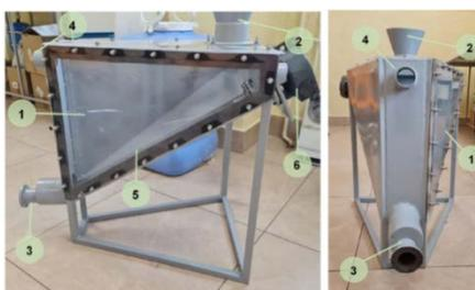
Рис. 3. Резервуар для аккумуляции и подачи гидросмеси в насосный агрегат. 1 – рабочая зона; 2 – воронка для загрузки гидросмеси; 3 – канал для подключения к секции насосного агрегата; 4 – канал для отвода осветленной воды; 5 – расположение шнекового смесителя; 6 – привод смесителя
