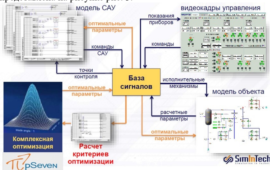
Рис. 3. Структура интеграции расчетной модели и платформы оптимизации
