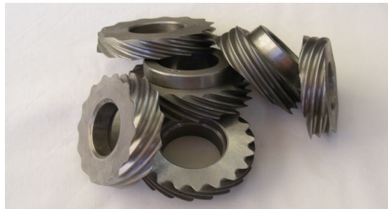
Рис.3. Спроектированные винтовые зубчатые поверхности.
