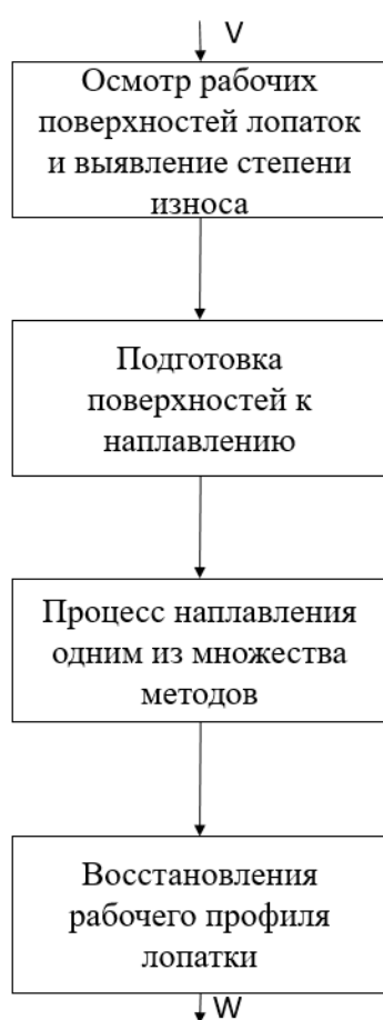
Рис. 2. Гипотетический алгоритм наплавления лопаток
