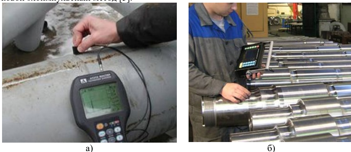
Рис. 1. Ультразвуковой контроль на отсутствие внутренних недопустимых несплошностей:
