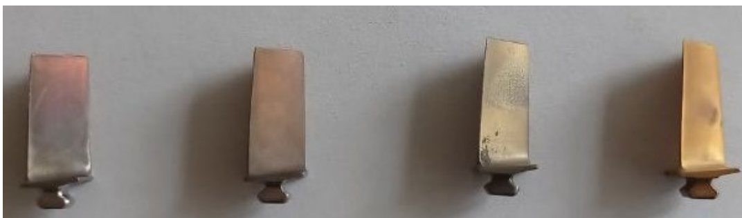
Рис. 4. Лопатки после реализации одного из возможных ТП ремонта и восстановления
