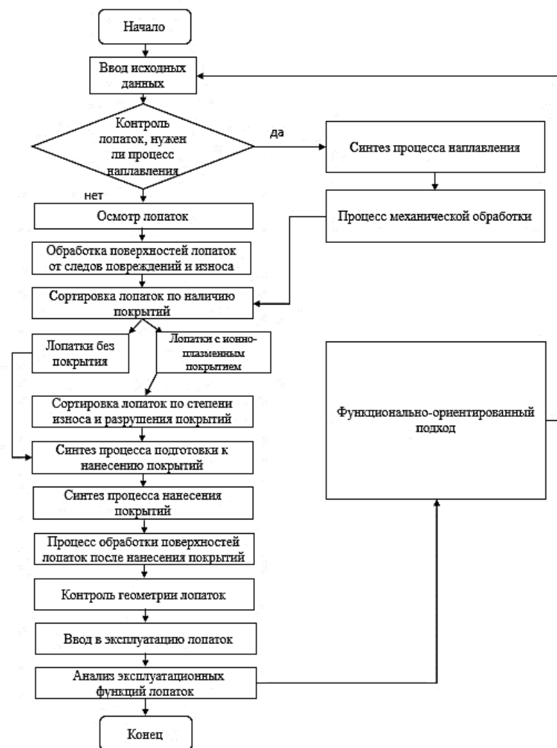
Рис. 3. Гипотетический алгоритм синтеза ТП ремонта и восстановления рабочих поверхностей лопаток
