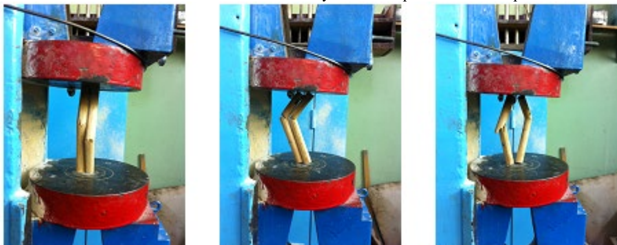
Рис. 3. Расположение одной стойки и двух стоек на рабочем столе пресса
