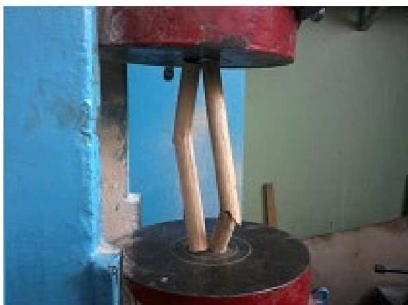
Рис. 5. Вид разрушения двух и четырех деревянных стоек при рассогласованном деформировании и разломе стоек на разной высоте
