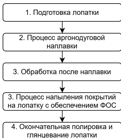
Рис. 3. Укрупненные этапы ремонта и восстановления лопаток ГТД
