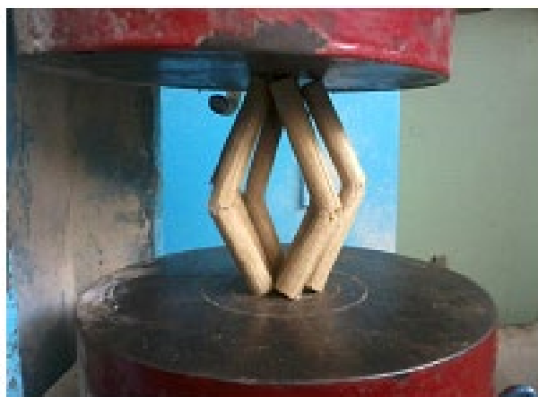
Рис. 5. Вид разрушения двух и четырех деревянных стоек при рассогласованном деформировании и разломе стоек на разной высоте
