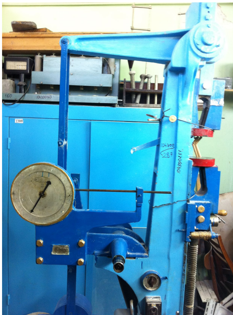
Рис. 2. Общая вид пресса для проведения испытаний прочностных свойств деревянной крепи
