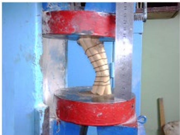
Рис. 9. Вид разрушения четырех деревянных стоек с гибкими стяжками при нарушении крепежа верхнего конца стяжки на стойке
