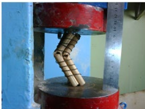
Рис. 8. Вид разрушения четырех деревянных стоек с гибкими стяжками при различной высоте разлома стоек
