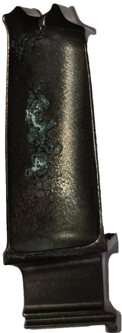
Рис. 1. Эрозионное разрушение лопатки турбины
