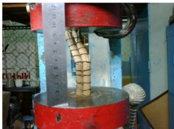
Рис. 7. Вид разрушения двух деревянных стоек с гибкими стяжками при различной высоте разлома стоек
