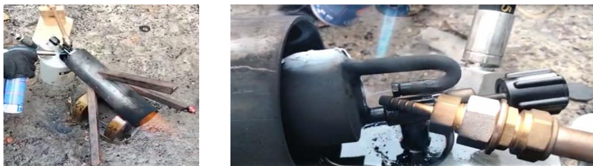
Рис. 4. Схема использования перегретого пара (справа) для эффективного распыливания ДТ в условиях предварительных испытаний макетной установки (слева – общий вид)
