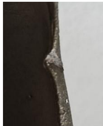
Рис. 2. Забоина на кромке лопатки
