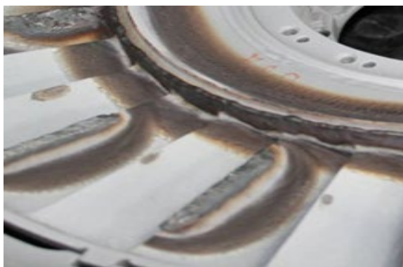
Рис. 3. Лопатки турбины после технологического процесса ремонта (после операции наплавления)
