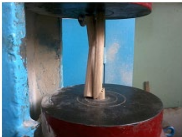
Рис. 6. Вид разрушения двух стоек без стяжки и четырех стоек со стяжкой при деформации стоек за счет их смятия на концах
