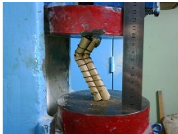
Рис. 8. Вид разрушения четырех деревянных стоек с гибкими стяжками при различной высоте разлома стоек
