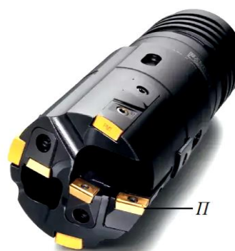
Рис. 2. Сверло системы ВТА: П – периферийный режущий элемент
