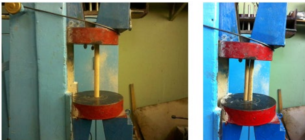
Рис. 3. Расположение одной стойки и двух стоек на рабочем столе пресса
