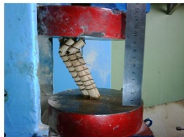
Рис. 9. Вид разрушения четырех деревянных стоек с гибкими стяжками при нарушении крепежа верхнего конца стяжки на стойке
