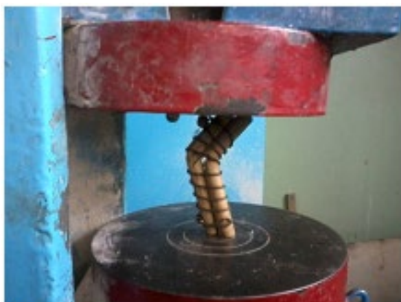
Рис. 7. Вид разрушения двух деревянных стоек с гибкими стяжками при различной высоте разлома стоек
